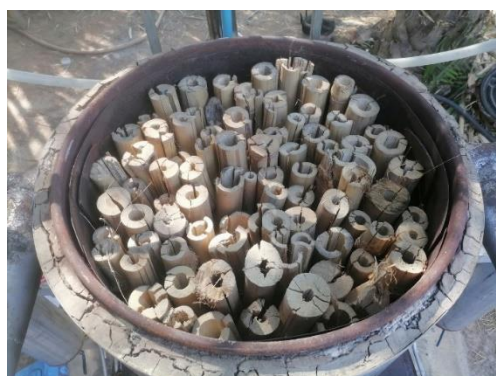
ภาพที่ 8. ตัดไฟยาว 80 ซม. และทุบให้ปล้องไม้ไฟแตก
